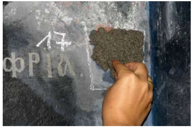
Сл. 14. Сонда при ирејман со 5% амониум хидроген карбонај:
